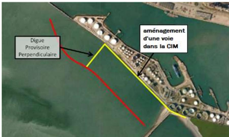
Figure 15 : Ouvrages provisoires en phase travaux
